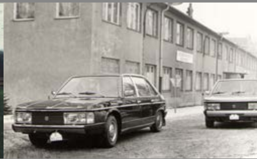
Luxusnější verze Tatra 613 Special ze začátku 80. let měly prodloužený rozvor o 150 mm s důrazem na co nejvyšší pohodlí cestujících. Nechyběla např. klimatizace nebo tempomat, ve střední části zadního opěradla byl umístěn atraktivní minibar.
